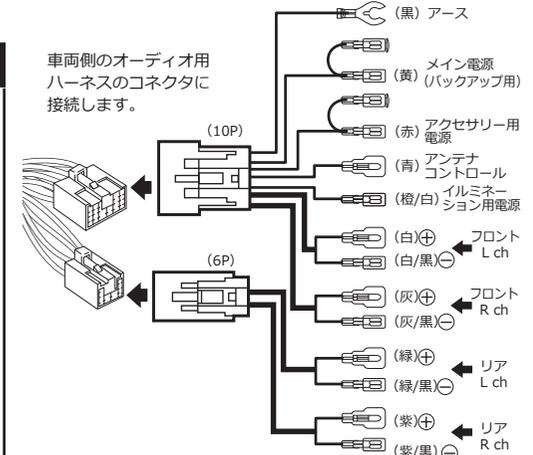
※6ピンコネクタが無い車の場合、リアスピーカーの配線はスピーカーに付属しているコード等を使用します。
