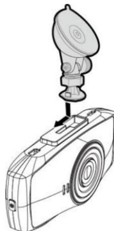
3. 吸着カップをフロントガラスに平行に押し付けます。
