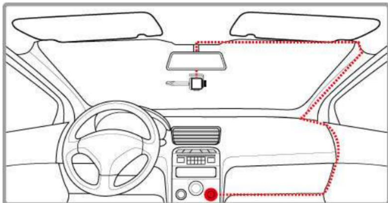
1. 電源コネクタの一方の端を機器の電源コネクタポートに接続します。USBポート入力 DC 5V / 1.0A
