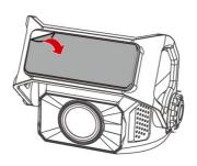
3. フロントガラスのガラス保護シールにブラケットの位置を合わせ、しっかりと押し付けます。所定の位置に確実に固定されていることを確認します。
