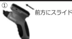
① モニターを前方にスライドさせ、モニターを外します。
